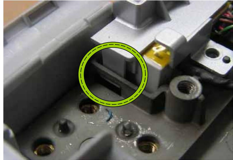
RELEASE THE CLIP ON EACH SIDE OF THE RJ-11 /RJ-45 BRACKET AND LIFT THE BRACKET UP
