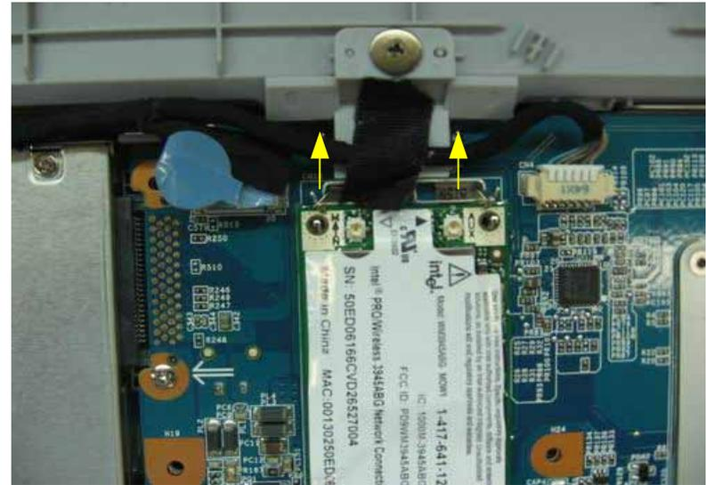
RELEASE THE WIRELESS CARD BY PRESSING THE TWO CLIPS AWAY FROM THE CARD
