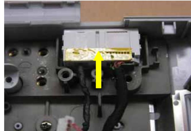
LIFT THE RJ-11 /RJ-45 HARNESS UP
