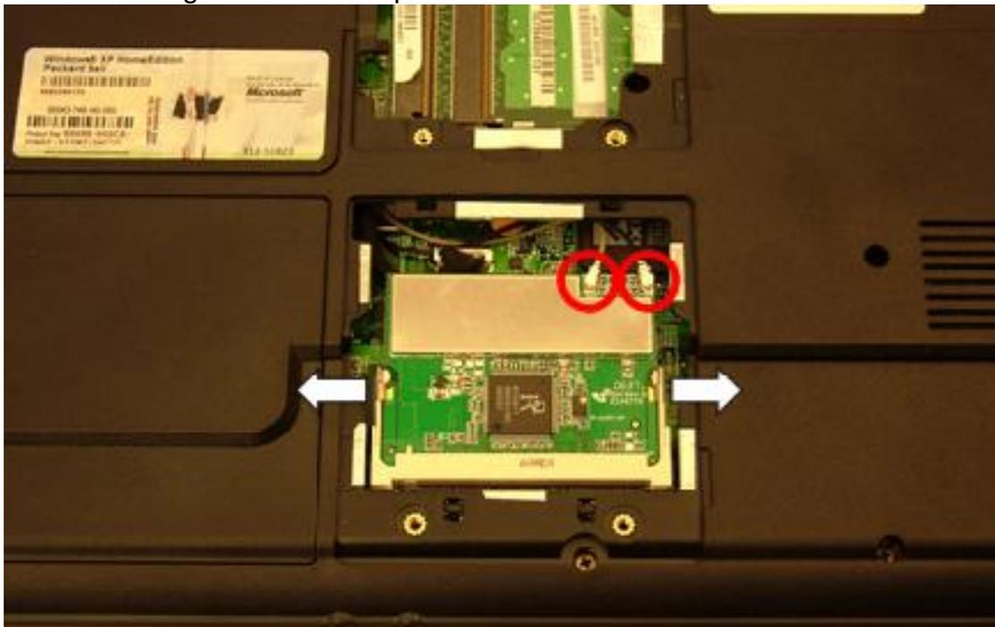
**Fig. 5** *The WLAN module.*
