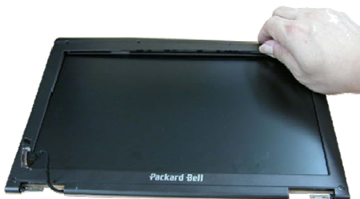
Fig. 21 Removing the LCD Bezel
